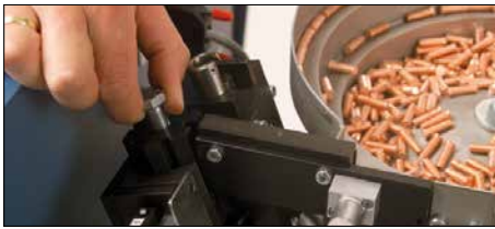
Blitzwechselsystem für die Umstellung auf andere Bolzendurchmesser (Pat.-Nr. DE 199 34 209 C2)
